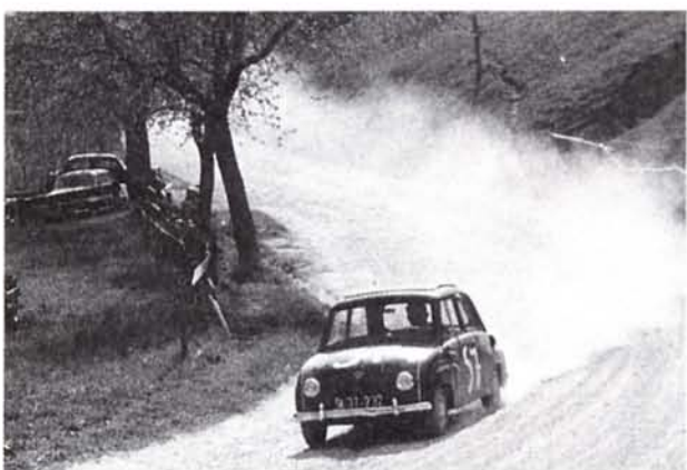
1959: Johann Schachner treibt sein Goggomobil mit Vollgas nach dem Heferer-Bühel der Hafner-Reith entgegen. Den Antrieb für das „Goggerl“ besorgte ein Zweizylinder-Zweitaktmotor mit 350 cm 3 . Die 12 PS reichten zum Klassensieg.
